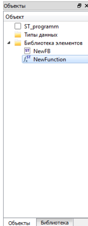
Рисунок 3.93 - Пользовательские функции и функциональные блоки в дереве объектов
